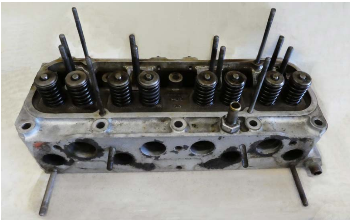
Ein- und Auslassbereich; Kipphebelmechanik entfernt
