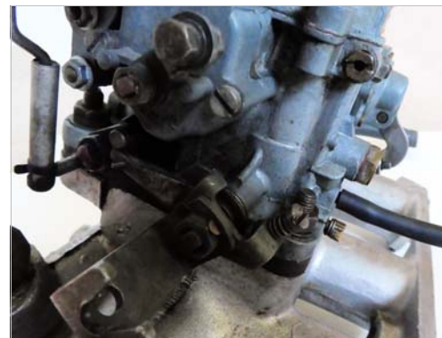
Kuplung zu Primär-Drosselklappe
