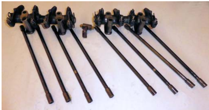
Kipphebelmechanik und Stößel
