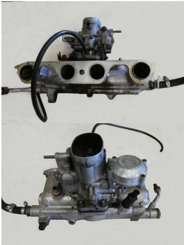
Entfernter Einlasskrümmer mit Solex Doppelvergaser
