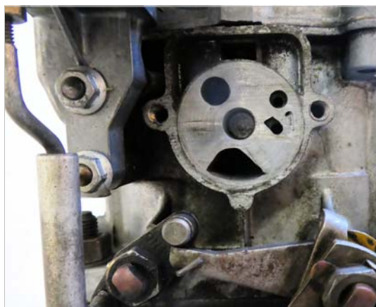
Geöffnetes Choke-Ventil
