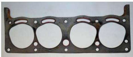
1 Zylinderkopf-Dichtung
