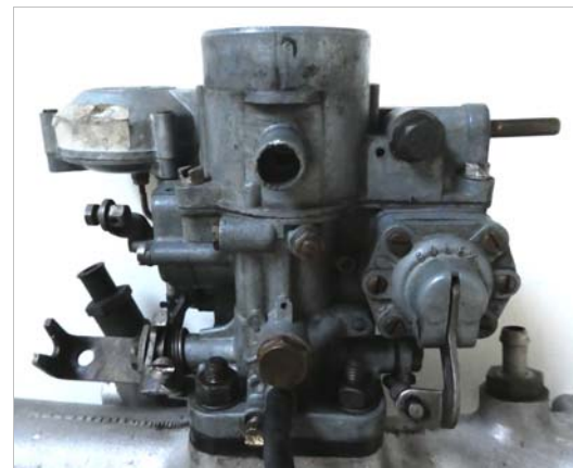
Beschleunigungs-Pumpe
