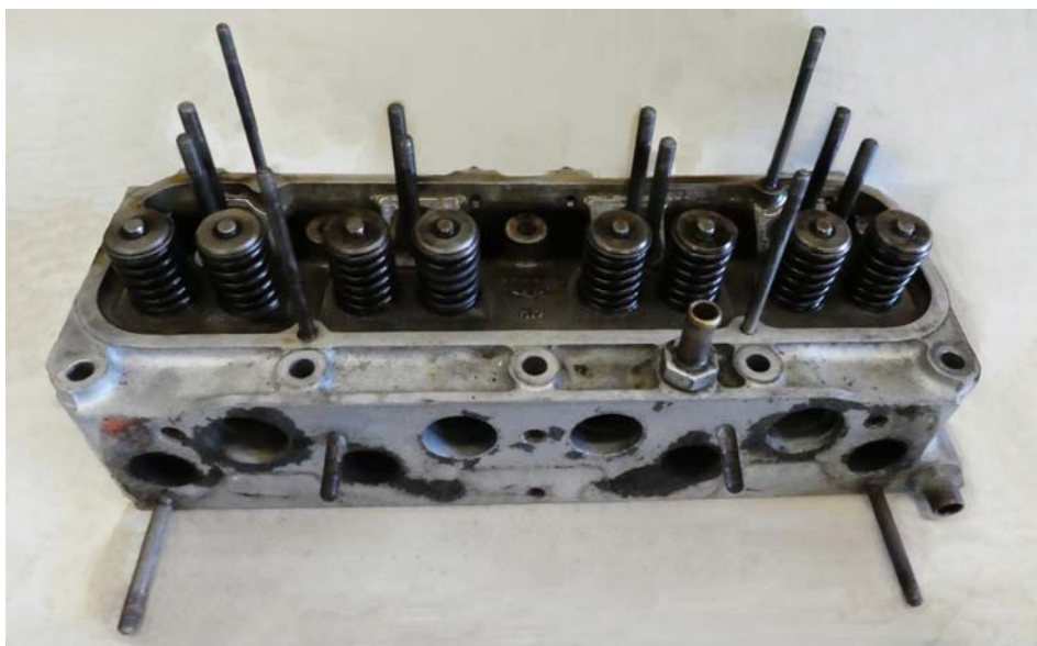
Auspuffkrümmerseite des Zylinders
