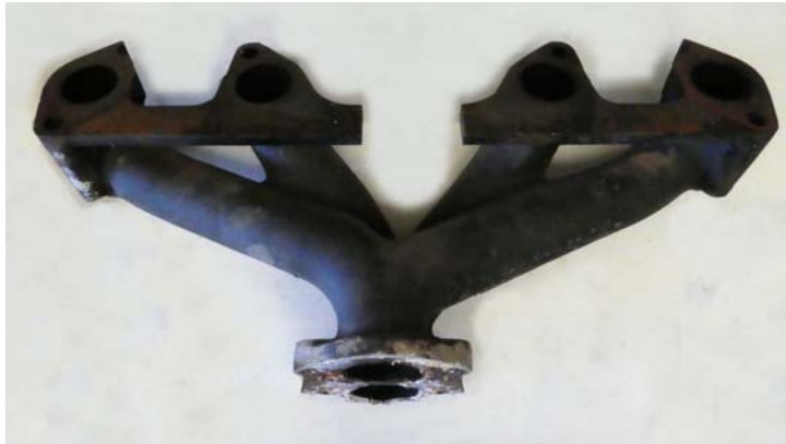
Motorseite des Auspuffkrümmers
