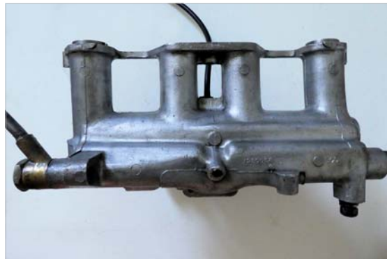
Vergaser mit Einlasskrümmer, unten
