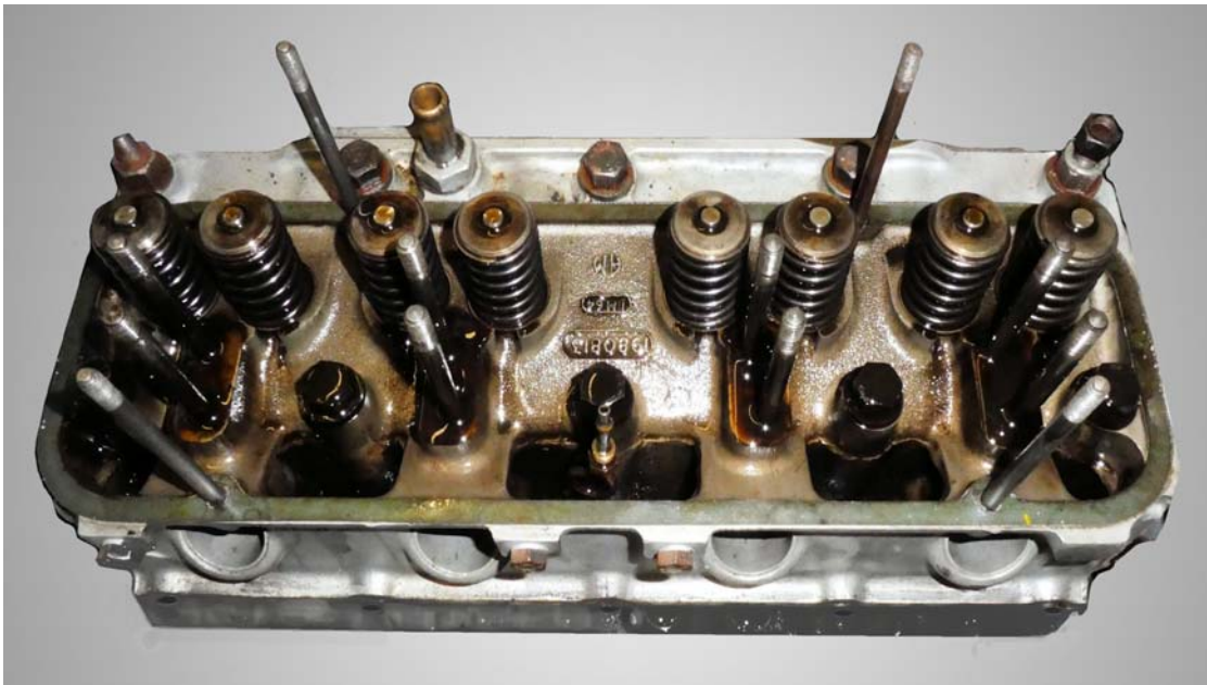
Ventil- und Zündkerzenbereich; Kipphebelmechanik entfernt
