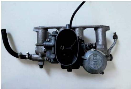
Vergaser mit Einlasskrümmer, oben
